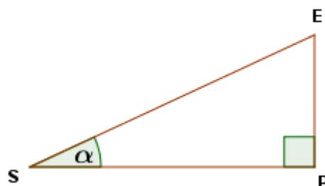
Tenemos que calcular el ángulo  $\alpha$  y la longitud del segmento  $\overline{SP}$ . Como conocemos la longitud de la hipotenusa  $\overline{SE} = 2,9m$  y la del cateto opuesto al ángulo  $\alpha$ , es decir  $\overline{EP} = 0,5m$ , podemos vincular todos estos datos mediante el seno del ángulo:
